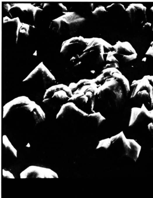
Abb. 2. \text{MgSi}_2 -Kristalle auf einer \langle 111 \rangle -Siliciumoberfläche im ersten Stadium der Reaktion (REM-Aufnahme, Vergrößerung 1400-fach).
