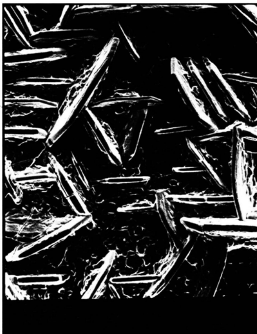
Abb. 3. \text{CaSi}_2 -Kristalle auf einer \langle 111 \rangle -Siliciumoberfläche (REM-Aufnahme, Vergrößerung 200-fach).
